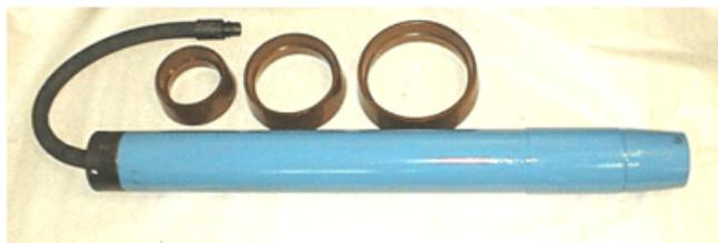
Пневмомолот Тайфун-70 с комплектом колец для соединения с забиваемой трубой диаметром 159, 219 или 273 мм
