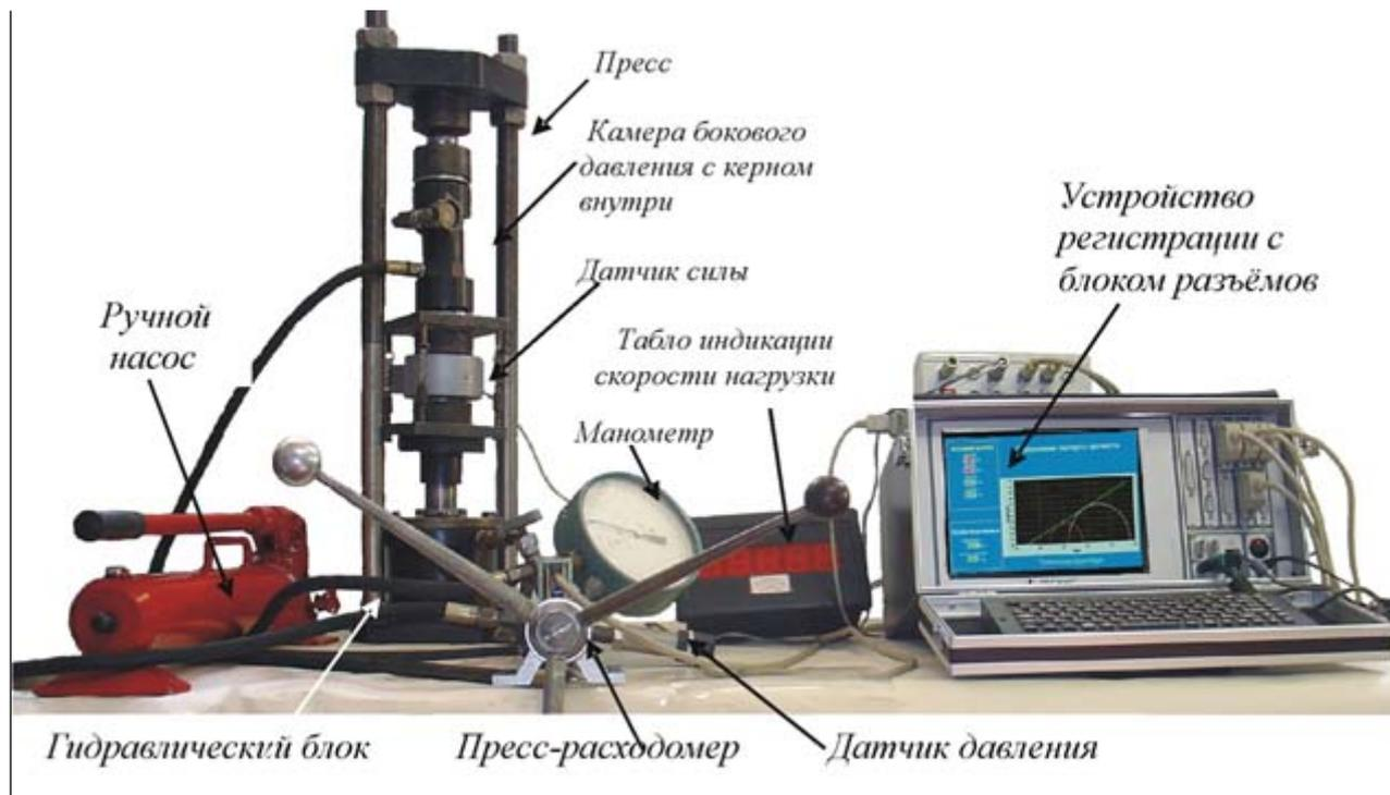
Приборный комплекс позволяет определять параметры прочностных свойств горных пород с построением паспорта прочности при объёмном нагружении образцов кернов: предел прочности на сжатие, предел прочности на растяжение, сцепление, угол внутреннего трения.
