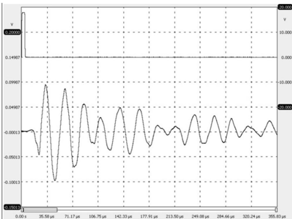
Осциллограмма сигнала от датчика с продольными колебаниями
